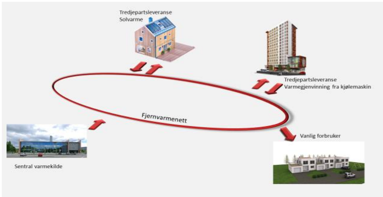
Figur 7.4.7: Fjernvarmenett alternativ 3, «Zero Emission Neighborhood»
